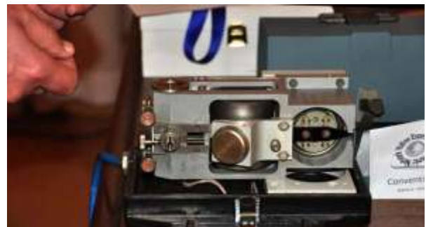
Un sensore orizzontale/verticale a 2 sec di periodo di risonanza, di produzione russa acquistato da Paolo Frediani
